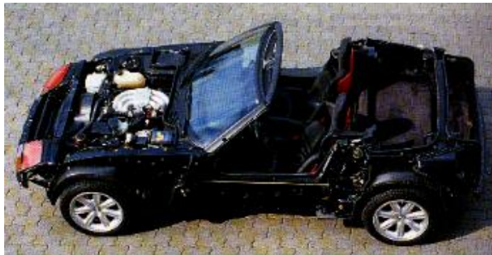
Z1 entièrement assemblé, en attente de sa carrosserie composite
