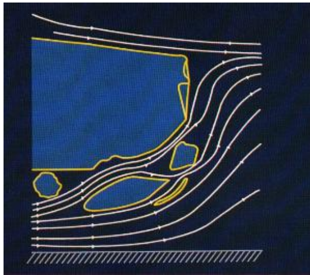
Flux d'air autour du silencieux arrière et des panneaux de carrosserie
