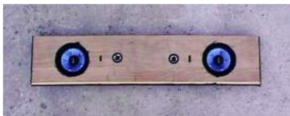
Vue avant, sans le grillage, ni la moquette acoustique
